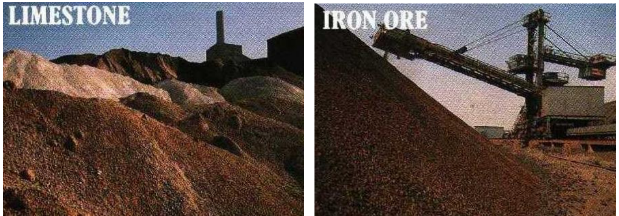
Figura 14 - Vista dei parchi di materie prime per la produzione di minerale sinterizzato.
