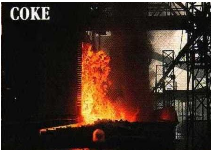
Figura 6 - Estrazione del coke da una cella di produzione
