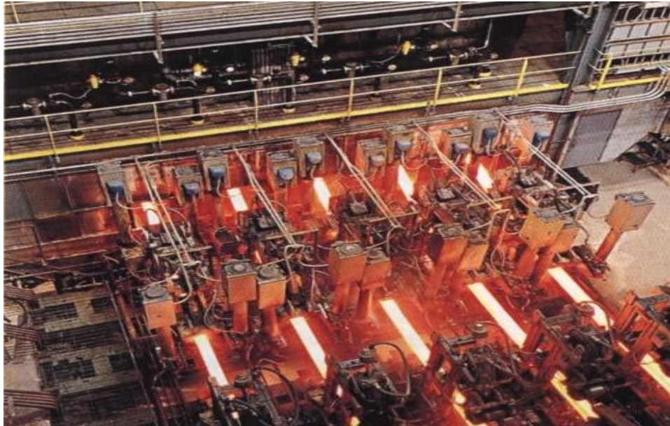
Figura 9 – Macchina di colata continua a 5 linee per la produzione di billette.
