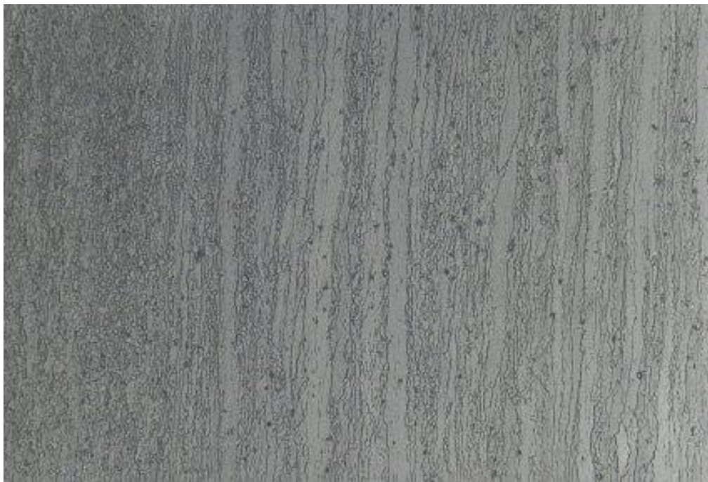
Figura 16 – Micrografia dell' acciaio inox ferritico AISI 441 laminato a caldo, ricotto e decapato. Ingrandimento 100x. Bordo dello spessore del nastro.
