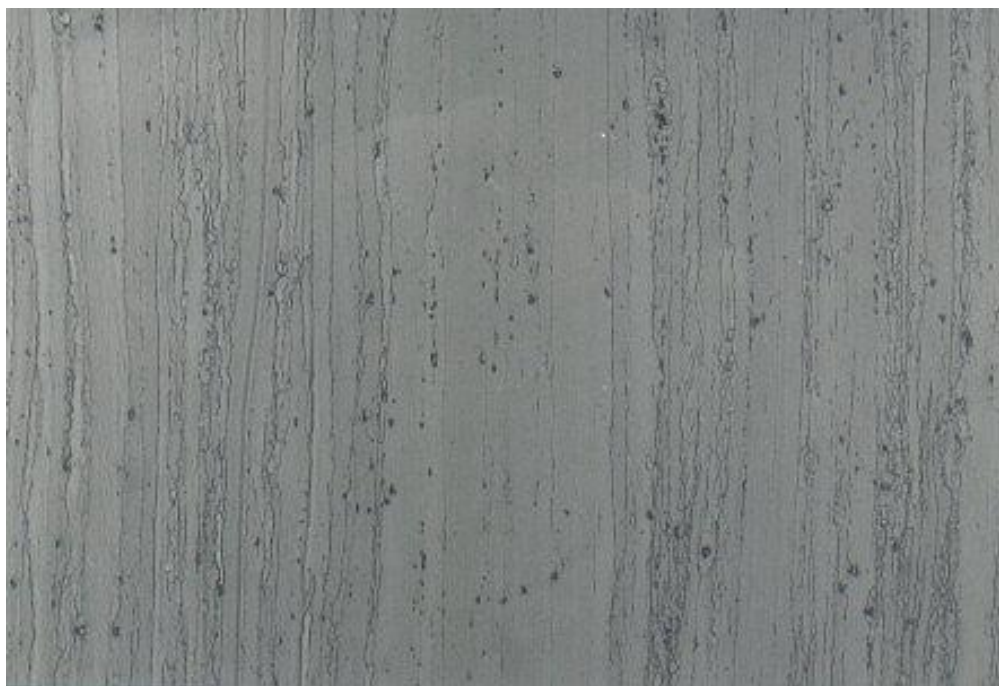
Figura 17 – Micrografia dell' acciaio inox ferritico AISI 441 laminato a caldo, ricotto e decapato. Ingrandimento 100x. Centro spessore del nastro.
