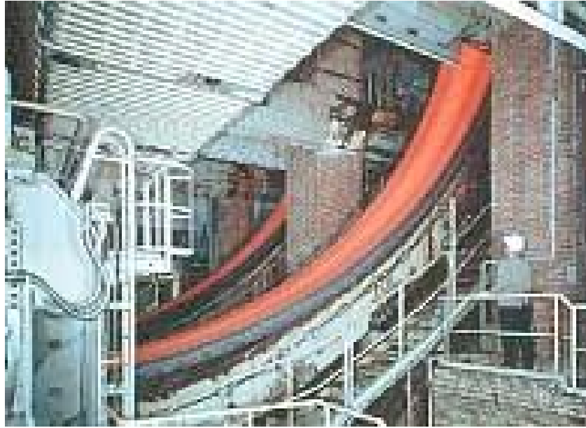
Figura 11 – Colaggio di una bramma in continuo.
