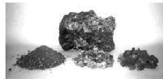
Figura 2.7- Scorie di forno ad arco elettrico (in secondo piano) e prodotti della lavorazione [5].
