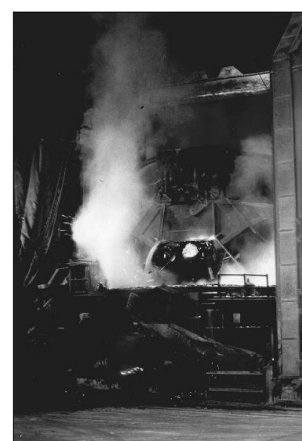
Figura 2. 7 – Carica del rottame nel FEA [5]
